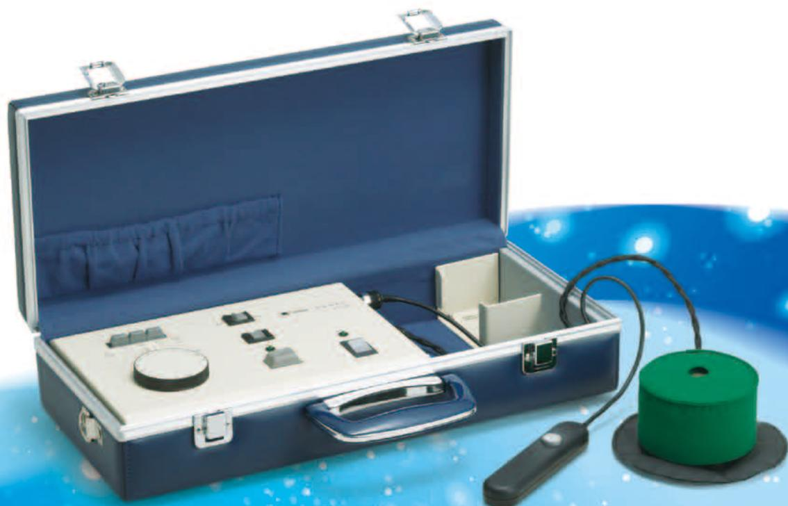
伐木、穿孔作業などの振動工具(チェーンソー、削岩機等)、タイプ作業などによる感覚域値測定、検査・研究に有効
