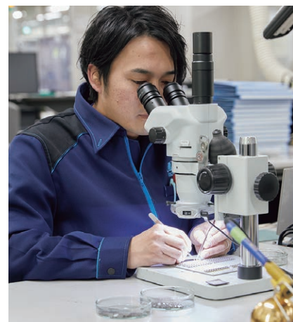
軟骨伝導補聴器の心臓部である振動子の製造現場。
