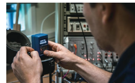
ノルソニック社のエンジニアが行うキャリブレーションの様子
