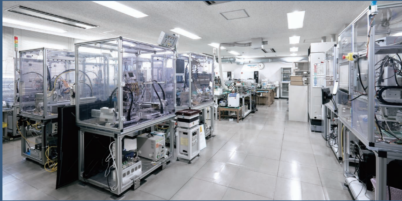
手前側に並んでいるのが、補聴器用マイクロホンの自動製造ロボットだ。各ロボットのサイズは、縦横が1メートルほど、高さが2メートルほどである。
